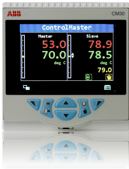
Fig. 2: Cascade template display
