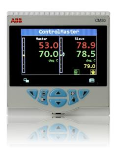
Fig. 2: Cascade template display
